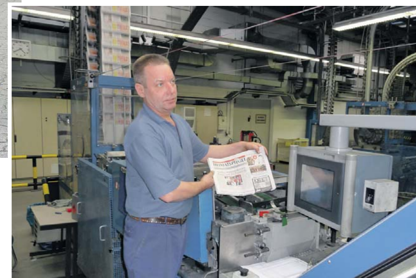
Hier werden in die gedruckten Zeitungen die disponierten Beilagen maschinell eingesteckt.
